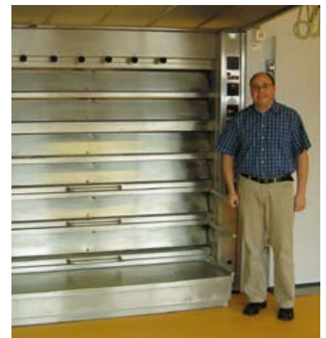
Remo Wüst vor dem grossen Backofen, bei dem das Thermoöl durch Erdgas erhitzt wird.
